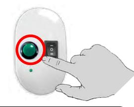
'A programozó nyomógomb sorozatos benyomásával a szerelési kábelen növeljük az alsó végállás sávját
