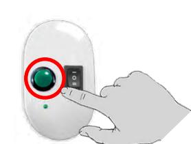
Kolejnymi wciśnięciami przycisku programowania na przewodzie montażowym zwiększymy zakres dolnego położenia krańcowego.
