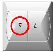
Po dosażeniu dolní polohy zapínáme a vypínáme napájení (x3) směrem dolů v intervalach 0,5 s
