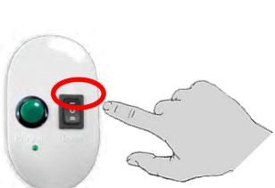
Porniți servomotorul în direcția sus.
