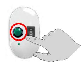
Prin apăsarea din nou a butonului de programare de pe cablul de montaj, creștem intervalul pozitiei de capăt inferioară.
