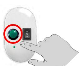
Kolejnymi wciśnięciami przycisku programowania na przewodzie montażowym zwiększymy zakres górnego położenia krańcowego.
