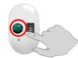
Bei den nächsten Betätigungen der auf der Montageleitung lokalisierten Programmierungstaste wird der Bereich der unteren Endlage vergrößert.
